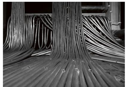
Neue Bleihöhre der pneumatischen Traktur
